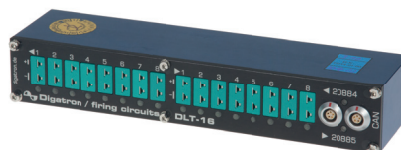
CAN-DLT Temperaturlogger für 16 zusätzliche Thermoelemente
